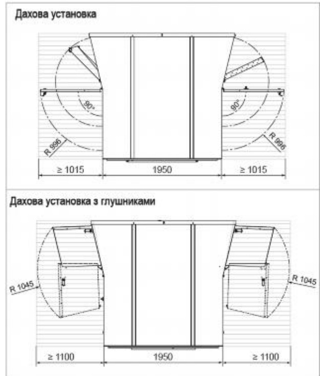
Мал. F4: Вимоги до простору для технічного обслуговування на даху (розміри в мм)
